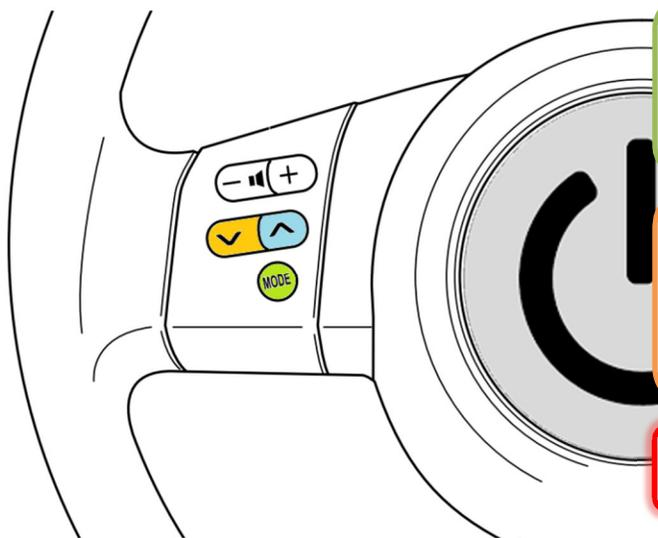
В **комбинированном режиме** управления, пользователь может активировать любую из подключенных камер, штатными кнопками управления на руле. Для этого используются всего три кнопки: «**MODE**», «**SEEK+**», «**SEEK-**». Ниже описаны алгоритмы управления и выбор различных режимов при помощи штатных кнопок на руле.
